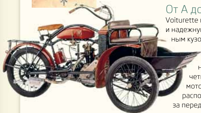
Трехколесный мотоцикл Type LW образца 1911 г. Литера W в названии модели обозначала двигатель с водяным охлаждением
